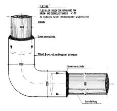
Gegenüber dem bisher verwendeten starren Verbindungsbogen zwischen Fallrohr und Grundleitung werden diese durch einen flexiblen 90°-Bogen mit längeren Schenkeln verbunden, um Belastungen durch Erddruck und Zug auszugleichen, die im Zuge von Verdichtungsarbeiten auftreten.
